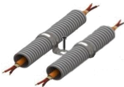
Рис. 3.4.3 Пример прокладки двух параллельных линий
