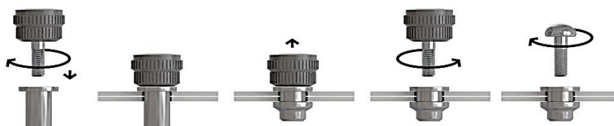
Рис. 4.4.1 Последовательность монтажа заклепки резьбовой с винтом
